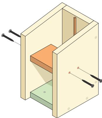
4. Das Zwischenbrett wird im Abstand von 12 cm zum Bodenbrett und 5 cm Abstand zur Rückwand (lichtes Maß!) mit 4 Schrauben montiert. Fressfeinde sollen dadurch nicht zum Nest greifen können. Die Maße der Bohrlöcher stehen wieder auf Seite 2.
