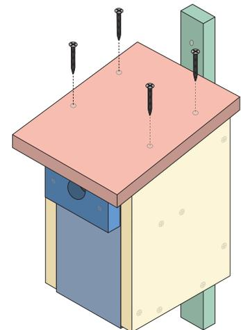
6. Zuletzt wird das Dach montiert, so dass der Dachüberstand vorn ca. 5 cm beträgt. Der Nistkasten muss nicht gestrichen werden. Bitte kein Leinöl verwenden, weil einige Säugetiere von dem Geruch angelockt werden. Das Dach ist mit Dachpappe langlebiger.
