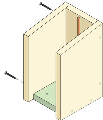
3. Das zweite Seitenteil wird mit 4 Schrauben befestigt. Den Kasten danach auf die Dachseite gedreht, lassen sich bequem 4 Löcher je  $\varnothing$  5 mm in das Bodenbrett bohren. Das dient dem Ablauf falls Feuchtigkeit eintritt.
