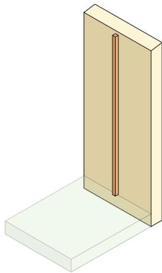
1. Alle Teile mit  $\varnothing$  3 mm Holzbohrer, wie auf Seite 2 angegeben, vorbohren. Mittig der Rückwand wird mit Abstand von 0,5 cm zur Dachkante die Ausstieghilfe geklebt (Holzleim). Die Vögel nutzen ihre Krallen, um an der Leiste hochzuklettern.
