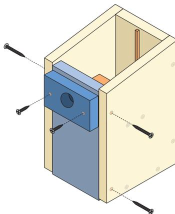
5. Nachdem in der Frontklappe und im Vorsatzbrett beide Einfluglöcher gebohrt und mit 2 Schrauben verbunden wurden, wird die Klappe rechts und links angeschraubt. Der Spalt zum Dach verhindert Hitzestau. Die Verschlusschraube dient dem späteren öffnen zur Reinigung im September.
