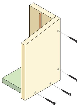
2. Die Montage geht am besten zu zweit. Rückwand und Bodenbrett wird im rechten Winkel aneinandergestellt. Das erste Seitenteil wird daraufgelegt und mit je zwei Schrauben am Boden und Rückwand befestigt.
